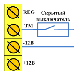
Рис. 8.2. Схема подключения скрытого выключателя
